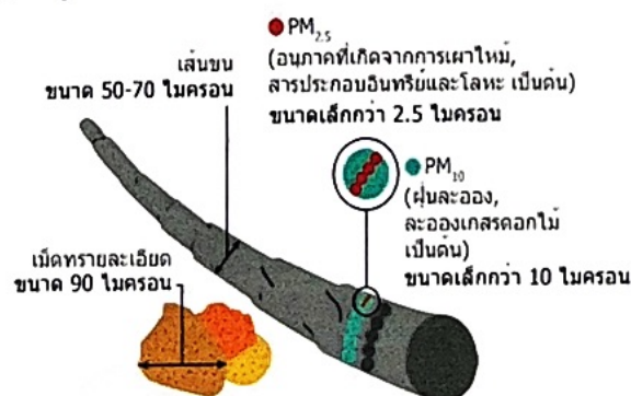
รูปที่ 1 ขนาดของฝุ่นละอองขนาดเล็กไม่เกิน 2.5 ไมครอน (PM 2.5 )
